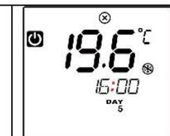
Терморегулятор поддерживает температуру защиты от замерзания 5° С. В любое время можно отменить режим работы нажав кнопку
