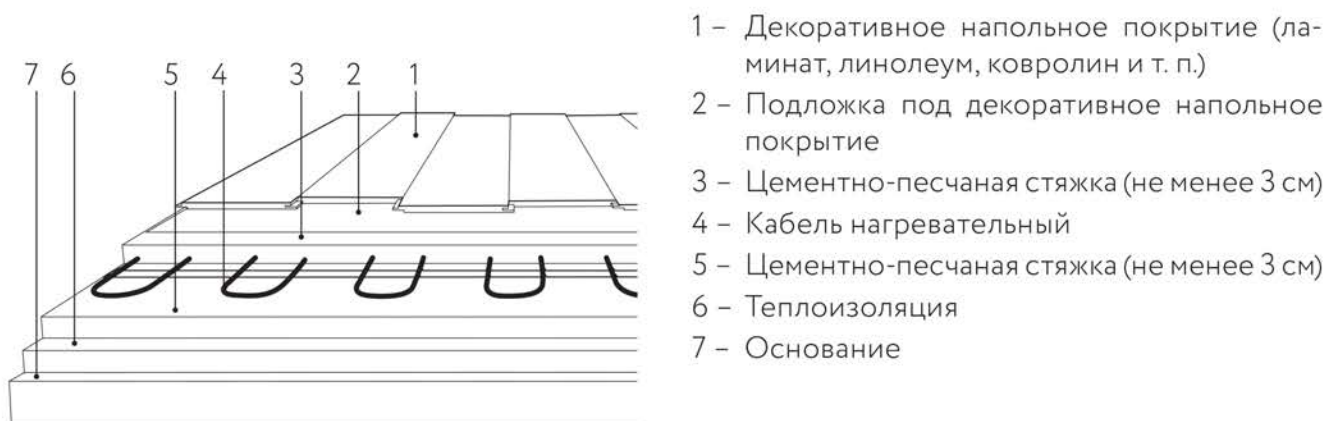
Схема укладки под ламинат, линолеум или ковролин в холодных помещениях
