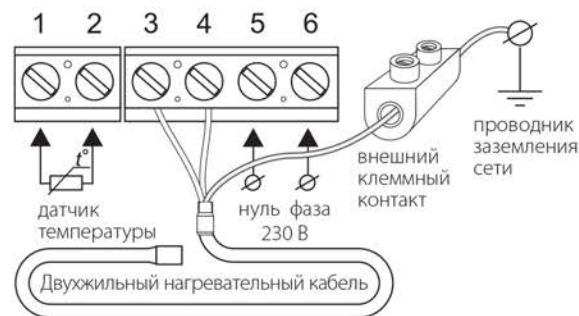
Схема подключения нагревательного кабеля «ONEKEYELECTRO» ОКЕ
