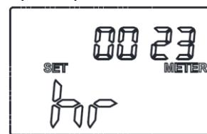
Терморегулятор ведет учет времени, считая полные часы, когда ваша система обогрева была включена.
