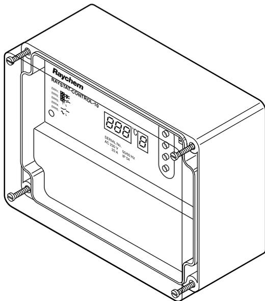
Программируемый термостат с регулированием по температуре обогреваемой поверхности с реле сигнализации RAYSTAT-CONTROL-10 разработан для простого и удобного для пользователя контроля и управления греющими кабелями. Термостат оснащен реле управления на 25 А (контакты можно скоммутировать «сухими») и однополюсным «сухим» реле сигнализации на два направления на 2 А.
