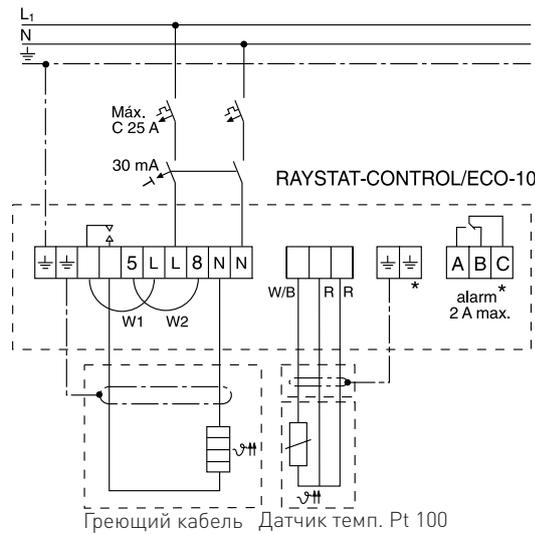
**Работа с «сухим» контактом: удалите перемычки W1 и W2**
