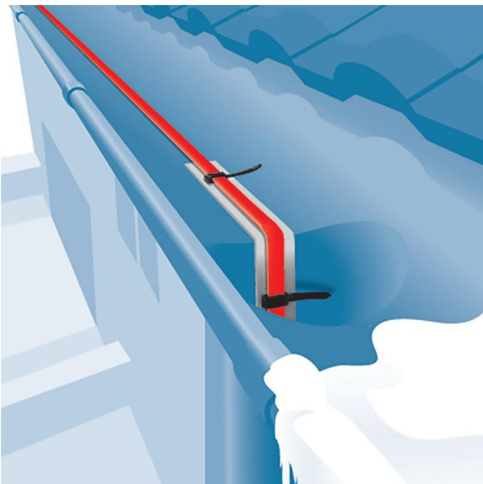
Все водосточные желоба и трубы, а также края кровли должны быть оснащены энергосберегающей системой обогрева на основе кабеля постоянной мощности nVent RAYCHEM GM-2CW или GM-4CW производства nVent, чтобы избежать повреждений кровли и водосточной системы в зимний период и образования сосулек.
