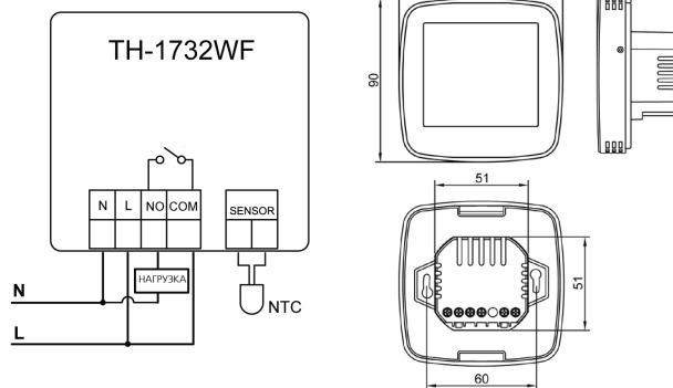
TH-1732WF является проводным программируемым комнатным терморегулятором, встраиваемым в подрозеточную коробку, с питанием от сети 220 В, с возможностью подключения выносного датчика температуры.
