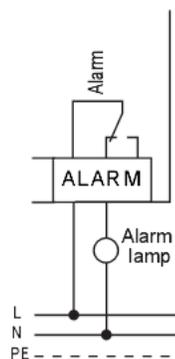
Подсоединение лампы предупреждающего сигнала (схема) или звукового сигнала (нерабочее положение)
