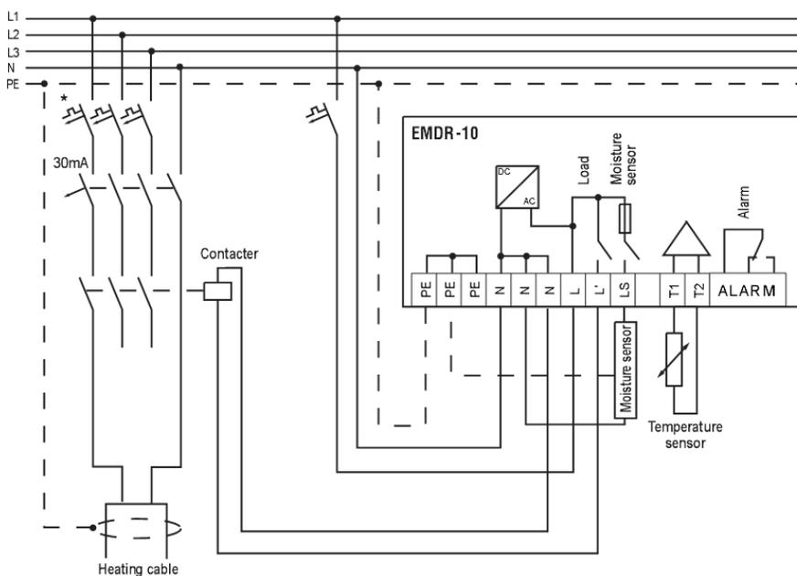
\* Номинальная настройка автомата защиты зависит от максимальной длины нагревательного кабеля (см. пункт 2.5)
