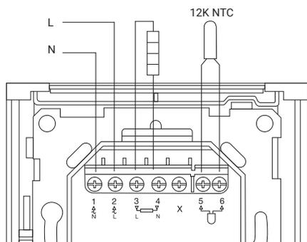
Подключение через контактор (многоконтурный нагрев)
