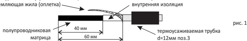
2. Снять полупроводниковую матрицу, не повредив внутренние жилы. Обрезать одну из нагревательных жил как показано на рис. 2. На вторую нагревательную жилу одеть термоусаживаемую трубку d 2мм поз. 2 и термоусадить ее термофеном.
