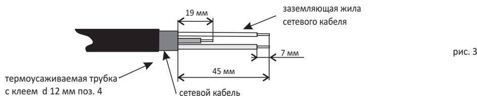
4. Вставить в соединительные гильзы ГСИ 2,5 жилы сетевого и саморегулирующегося кабеля. Обжать гильзы кримпером и термоусадить феном.
