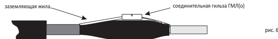
7. Надвинуть черную клеевую термоусаживаемую трубку d 18 мм поз. 4 так, чтобы она полностью закрывала места соединений и термоусадить ее с помощью промышленного фена. Нагревать трубку необходимо с середины к краям, чтобы внутри не оставалось воздуха.
